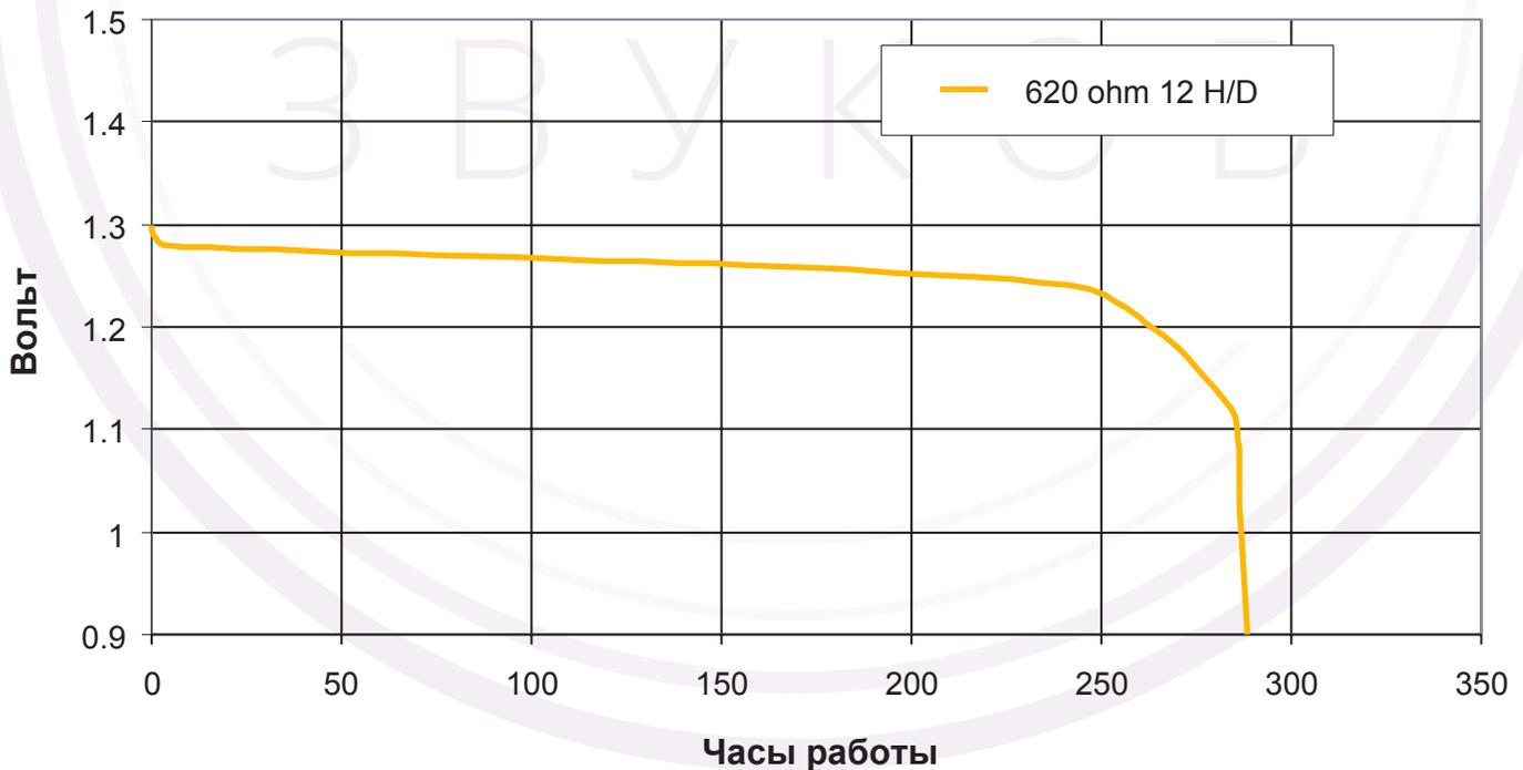
\* Мощности зависит от приложенной нагрузки, рабочей температуры и предельного напряжения. На диаграмме показаны соотношения энергии и срока службы который будет обеспечивать батарея.
